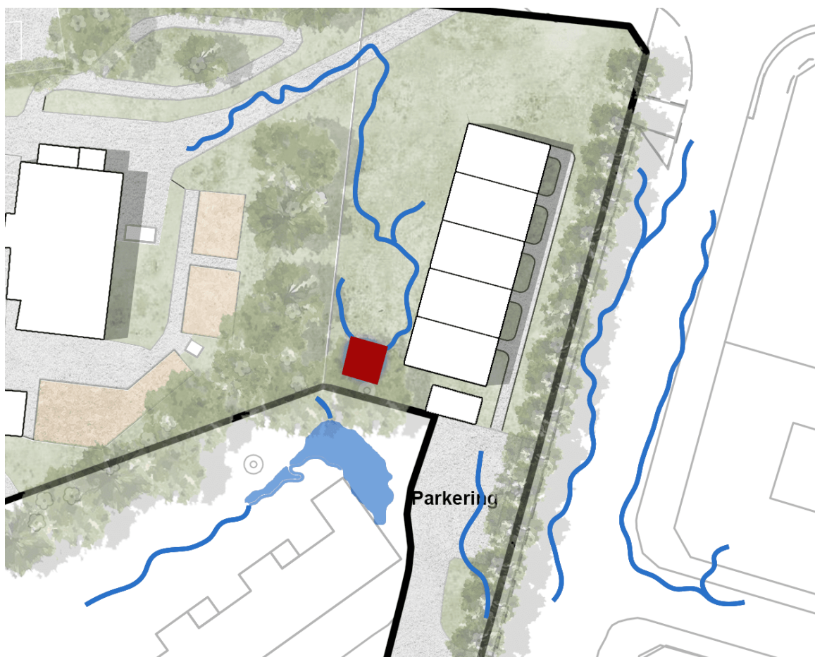
Figur 12: Förslag till placering av skyfallsanläggning. Blåa linjer visar avrinningsstråk.
