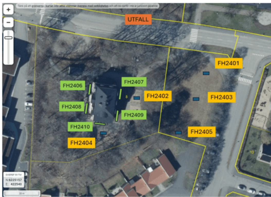
Figur 14: Utdrag ur markmiljöundersökningen, placering av maskingrävda provgröpar (FH2401-FH2405) och samlingsprover av ytlig jord för PCB-analys (FH2406-FH2410).
